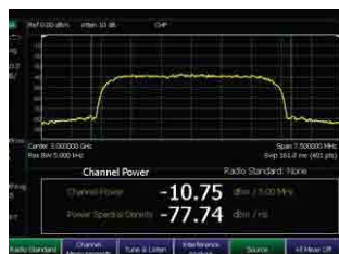
Измерение мощности в канале
